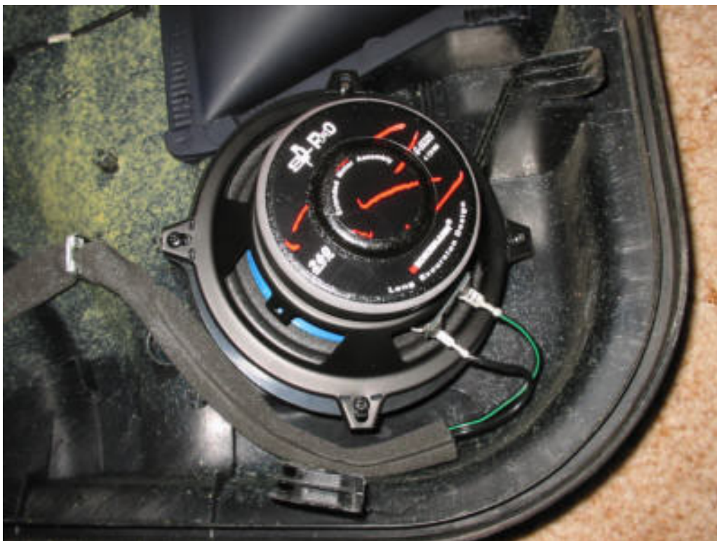
Mit Einbauhalterung und angeschlossenen Leitungen
