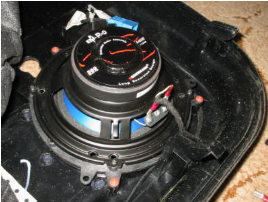
Der eingebaute Lautsprecher mit Einbauhalterung und neuen Kabelschuhen
