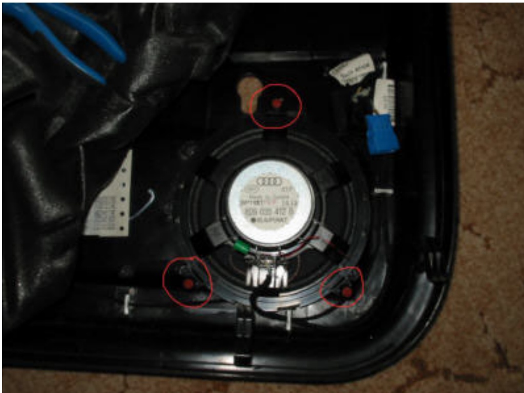
Zum Ausbau einfach den Stecker abziehen und die drei Schrauben lösen...
