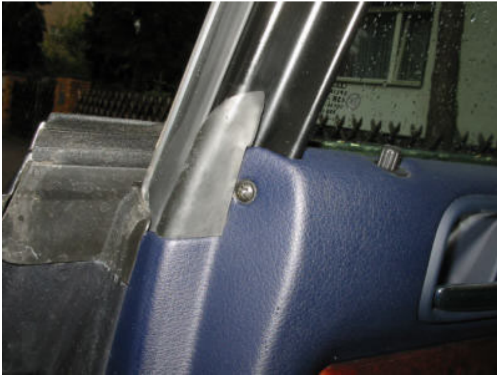
Zweite Schraube oben an der Türverkleidung bei der geöffneten Tür
